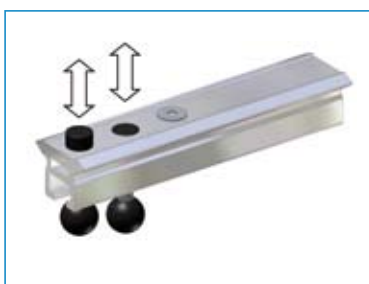
Butée d'extrémité mobile, qui permet l'entrée/sortie du chariot sur le rail en actionnant les plots mobiles.
