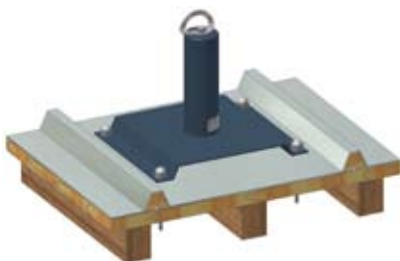
Fixation sur zinc-volige par 4 chevilles à bascule. (Épaisseur mini de la volige 12mm).
